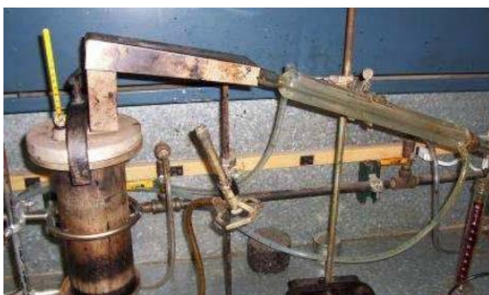
Figura 762 - 4. Equipo para el ensayo de destilación de emulsiones asfálticas
